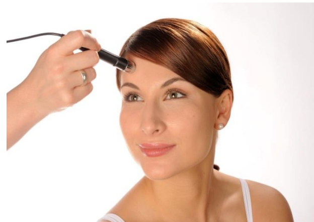
Foto 2 : de Corneometer® maakt snelle en eenvoudige hydratatie meting op verschillende huid sites mogelijk
